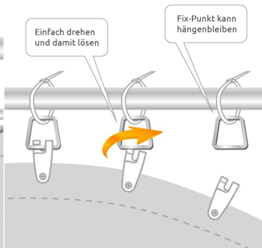
Die **Drehfix** werden von uns mit einem kleinen Edelstahl- Trapezring mitgeliefert. Dieser Trapezring wird als Fixpunkt mit Kabelbindern z.B. am Handlauf der Balkonumrandung befestigt. (**siehe Bild 2**) Die Laufhaken können nun in die Trapezringe um 90° eingehängt werden.
